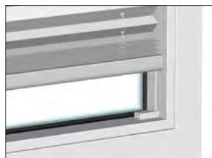
Glasleisten-Montage mit Spannshuhen
