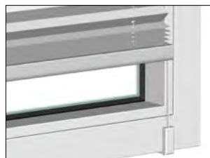
Fensterclip-Montage auf dem Fensterrahmen ohne Bohren und Schrauben
